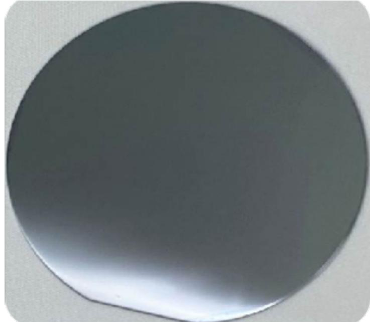
磁控直流溅射法要求靶材能够将从离子轰击过程中得到的正电荷传递给与其紧密接触的阴极，从而该方法只能溅射导体材料，不适用于绝缘材料。因为轰击绝缘靶材时，表面的离子电荷无法中和，这将导致靶面电位升高，外加电压几乎都加在靶上，两极间的离子加速与电离的机会将变小，甚至不能电离，导致不能连续放电甚至放电停止，溅射停止。故对于绝缘靶材或导电性很差的非金属靶材，须用射频溅射法（RF）溅射过程中涉及到复杂的散射过程和多种能量传递过程：入射粒子与靶材原子发生弹性碰撞，入射粒子的一部分动能会传给靶材原子；某些靶材原子的动能超过由其周围存在的其它原子所形成的势垒（对于金属是5-10eV）从而从晶格点阵中被碰撞出来，产生离位原子；这些离位原子进一步和附近的原子依次反复碰撞，产生碰撞级联；当这种碰撞级联到达靶材表面时，如果靠近靶材表面的原子的动能大于表面结合能（对于金属是1-6eV）这些原子就会从靶材表面脱离从而进入真空。
