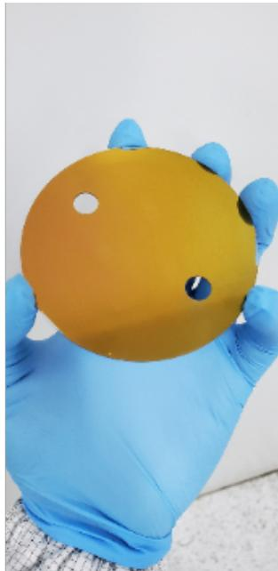
影响磁控溅射镀膜结果的因素：1、溅射功率的影响，在基体和涂层材料确定的情况下，工艺参数的选择对于涂层生长速率和涂层质量都有很大的影响. 其中溅射功率的设定对这两方面都有极大的影响。2、气压的影响，磁控溅射是在低气压下进行高速溅射，为此需要提高气体的离化率，使气体形成等离子体。在保证溅射功率固定的情况下，分析气压对于磁控溅射的影响。磁控溅射镀膜的产品优点：1、几乎所有材料都可以通过磁控溅射沉积；2、可以根据基材和涂层的要求缩放光源并将其放置在腔室中的任何位置；3、可以沉积合金和化合物的薄膜，同时保持与原始材料相似的组成. 磁控溅射镀膜的产品特点1、磁控溅射所利用的环状磁场迫使二次电子跳栏式地沿着环状磁场转圈. 相应地，环状磁场控制的区域是等离子体密度较高的部位。河南单靶磁控溅射设备随着工业的需求和表面技术的发展，新型磁控溅射如高速溅射、自溅射等成为磁控溅射领域新的发展趋势。
